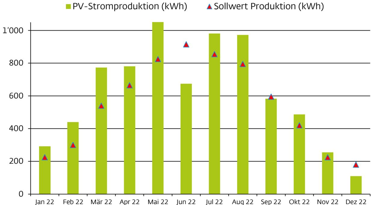
Der Solarstromertrag von der Photovoltaikanlage an der Klarastrasse in Allschwil betrug im Kalenderjahr 2022 insgesamt 7'464 kWh. Davon wurden 7'079 kWh oder 95% des produzierten Solarstromes an Primeo Energie abgegeben. 385 kWh oder etwa 5% konnten direkt vor Ort als Allgemeinstrom eingesetzt werden (Eigenverbrauch).
